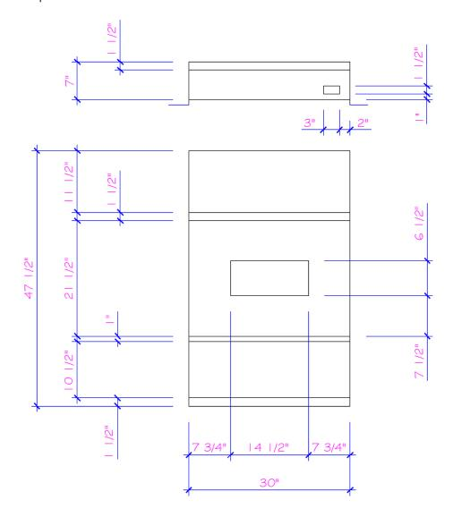
Terminez l'élévation en ajoutant les portes d'armoire. Débutez par les portes de droite et copiez-les vers la gauche en respectant la distance de 1". Utilisez le calque **EB-Const**.
