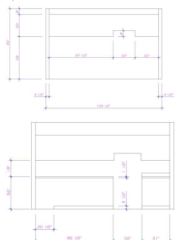
Ajoutez, sur le côté gauche de l'élévation, les objets à la verticale en vue de compléter le profil du comptoir et de l'armoire. La porte d'armoire, vue de côté, est juxtaposée sur la ligne verticale et fait 1/2" × 23".
